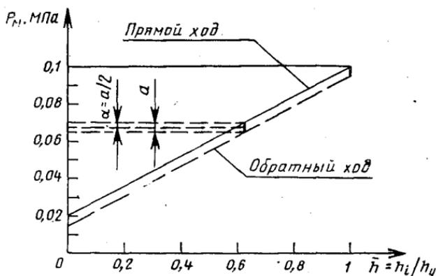
В случае неудовлетворительных результатов испытаний для клапанов, укомплектованных позиционером, допускается испытание на нечувствительность проводить с подключенным позиционером, при этом значение нечувствительности не должно превышать 2% от максимальной величины входного (командного) сигнала.
